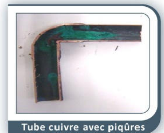
Tube cuivre avec piqûres
